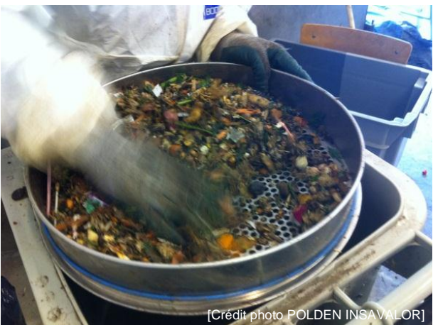
Criblage du sous échantillon : maille de 8 mm
