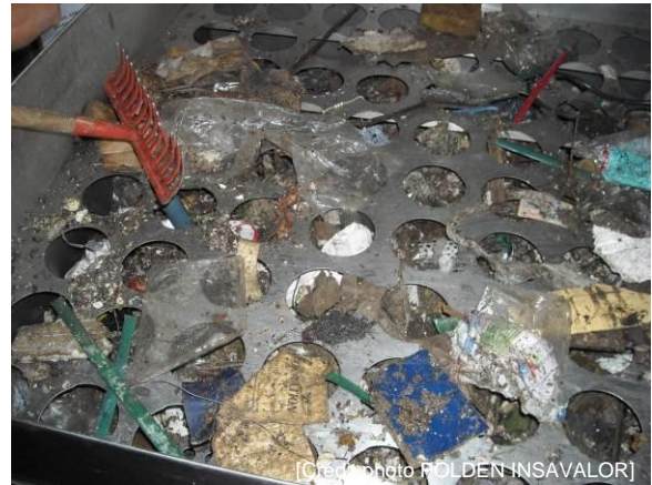
Criblage du sous échantillon : maille de 100 mm
