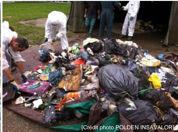
Ouverture et vidages des sacs avant homogénéisation
