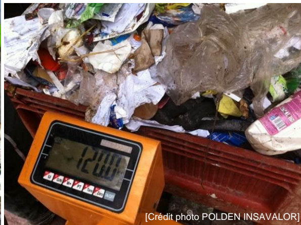
Pesée du sous-échantillon d'environ 120 kg
