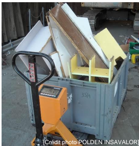
Transpalette peseur pour la pesée d'éléments > 400 mm
