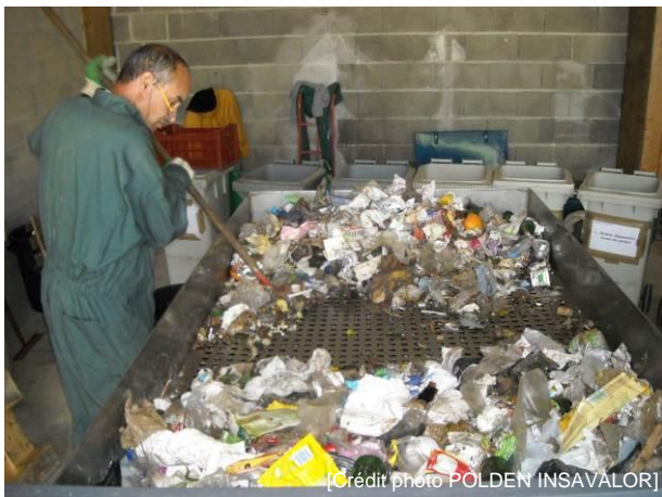
Criblage du sous échantillon : maille de 20 mm
