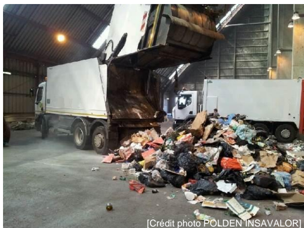
Déversement au sol du contenu d'une BOM d'OMr
