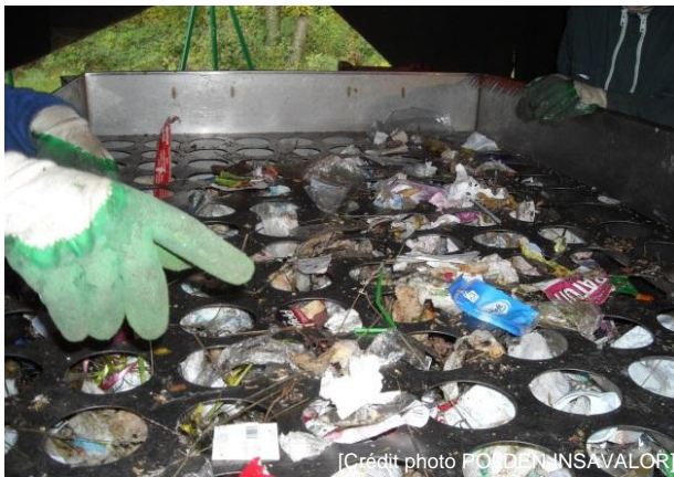
Criblage du sous échantillon : maille de 100 mm
